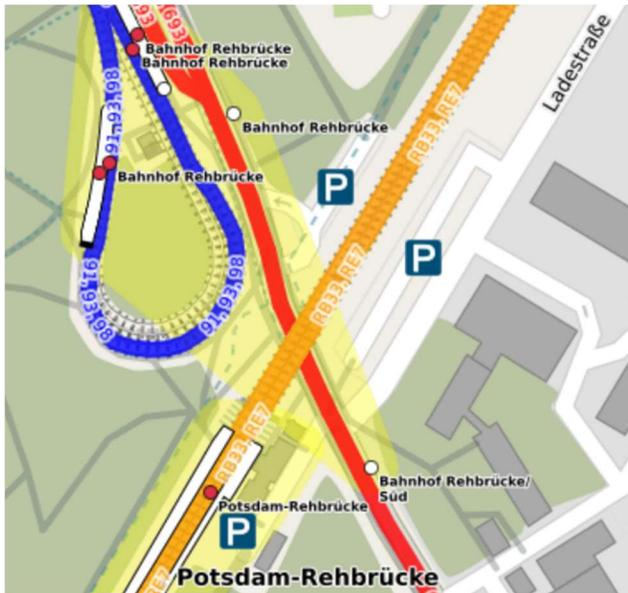
Durch Rückstau und fehlende Busspur kann der Busverkehr nicht an die Haltestelle am Bahnhof heranfahren. Der Bahnsteigzugang ist über eine Fußgängerbrücke möglich, mobilitätseingeschränkte Personen und Kinderwagen müssen den Bahnübergang benutzen. Mögliche Lösung: Ersatz der Fußgängerbrücke durch eine Fuß- und Radunterführung, Busspur von Süden bis zum Bahnhof, um Umsteigefahrgästen aus dem Bus das Aussteigen zu ermöglichen.
