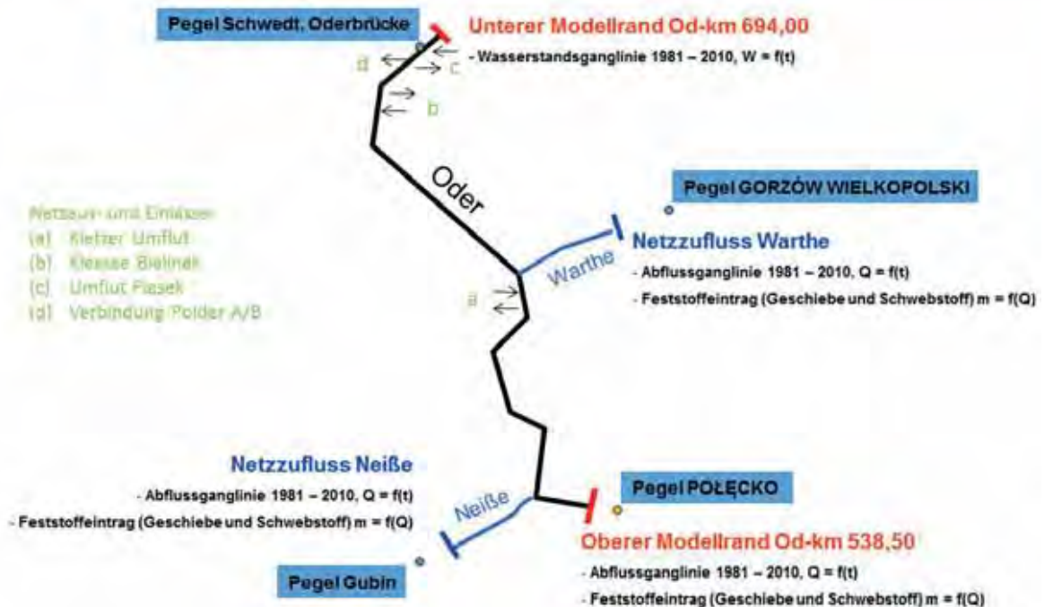
Bild 2-2: Modellnetz, Grenzoder mit Teilstrecken der polnischen Oder, Neiße und Warthe
