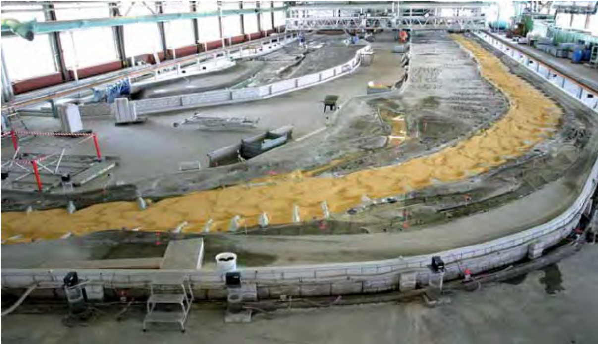
Bild 2-3: Physikalisches Modell der Oder bei Hohenwutzen in einer Versuchshalle der BAW
